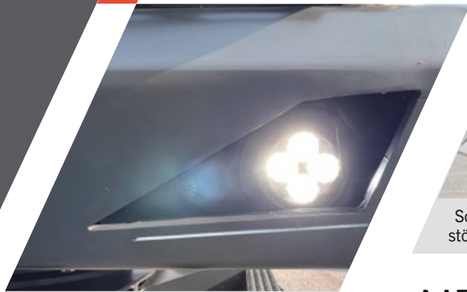
Neue LED-Scheinwerfer für einen geringen Stromverbrauch
